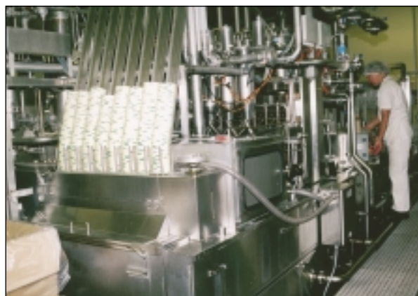
An dieser 13 Jahre alten Füll- und Verschließmaschine für Joghurtprodukte werden durch die Luftentkeimungsmaßnahmen nahezu aseptische Verhältnisse erreicht
