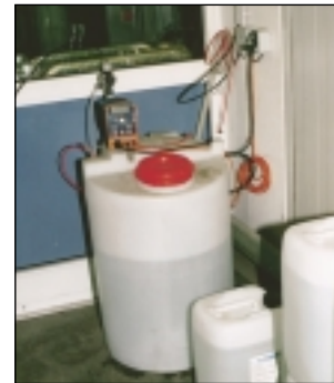
Der 100-Liter-Vorratsbehälter für die Maschinenentkeimung wird aus 20-Liter-Kanistern mit Wirkstoff nachgefüllt
